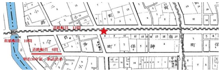
図2. 明治40年の測量図、図1と比べると市区改正道路が、俎橋の南側の位置に合わせて拡幅されたことが良く分かる。
